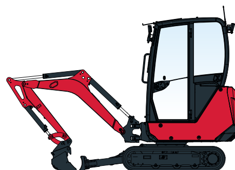
Long blade / long arm configuration
